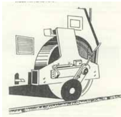
图 5.8.2 带切刀的压路机
